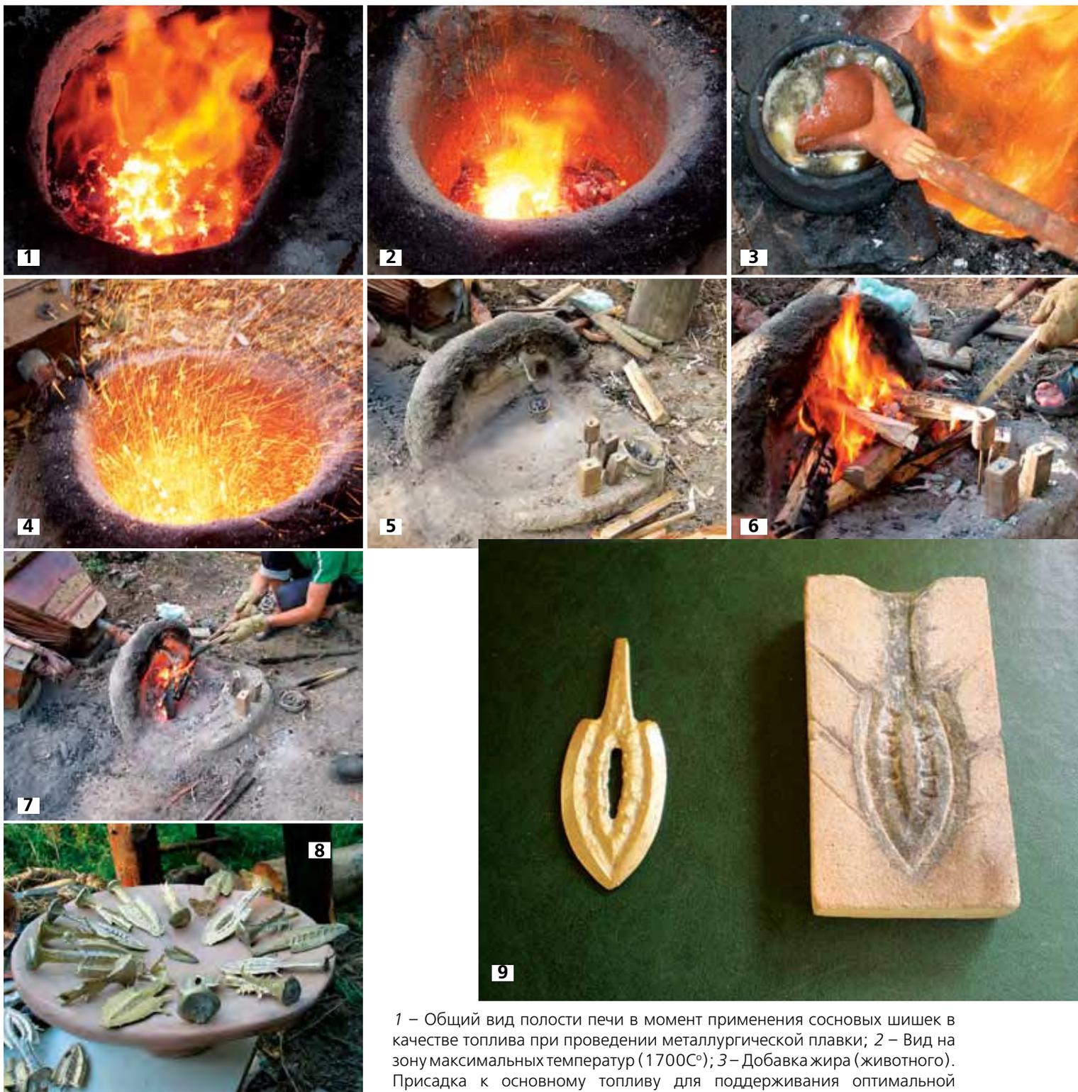
и несвоевременной подаче топлива. Эффект нехватки топлива в печи; 5 – Очаг, подготовленный для процесса отливки изделий; 6 – Разогрев тигля и металла. Без применения мехов. Прогрев литейных форм перед заливкой; 7 – Разогрев тигля и металла. Без применения мехов. Прогрев литейных форм перед заливкой; 8 – Готовые изделия. Выполнены школьниками г. Озёрска, Челябинской области; 9 – Реплика синташтинской стрелы, отлитой в рамках обучающей программы.
